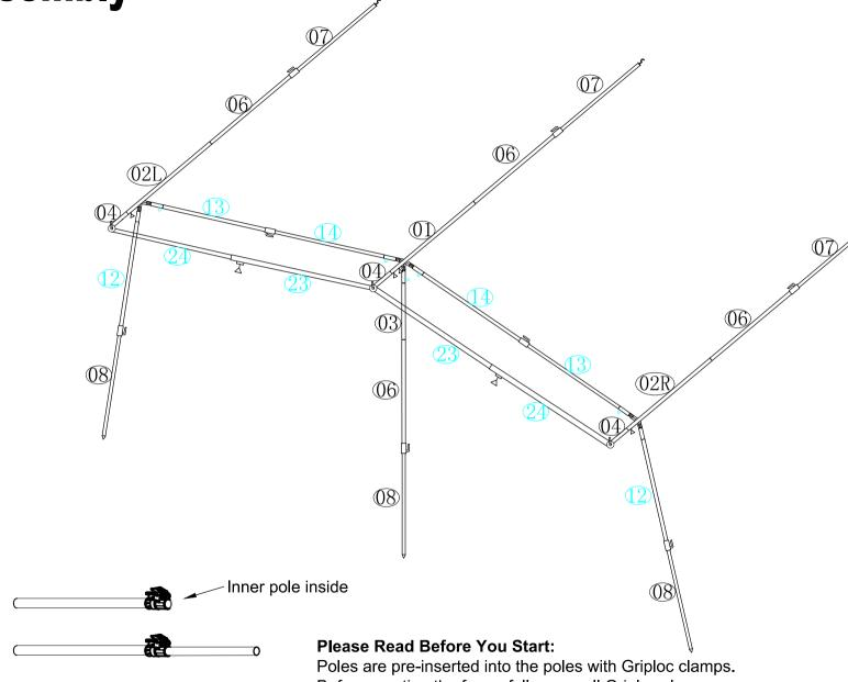
**Ø**25\*860mm 01 02 **Ø**25\*860mm 03 **Ø**25\*450mm 04 **Ø**22\*200mm **Ø**25\*1000mm 4 06 07 **Ø**22\*1000mm 08 **Ø**22\*1000mm **\$\phi**25\*1000mm **\$\phi**22\*1000mm **Ø**25\*1200mm **Ø**22\*1200mm **Ø**19\*1200mm
